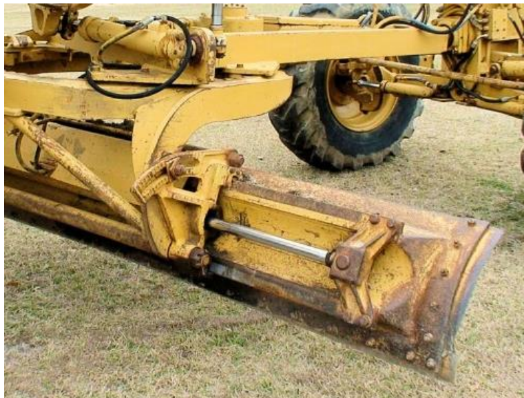
รูปที่ ๓-๓๙ การคว่ำหางยชูดใบมีดด้วยระบบไฮดรอลิค (บน) ใช้สลักขันล็อกด้วยมือ (ล่าง)
