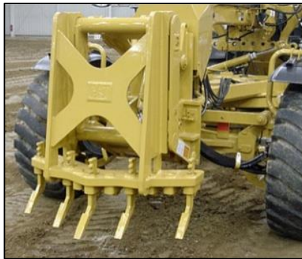
(ก) คราดขนาดเล็กที่ติดด้านหลังของรถ(ข) คราดขนาดเล็กที่ติดด้านหน้าชุดใบมีด
