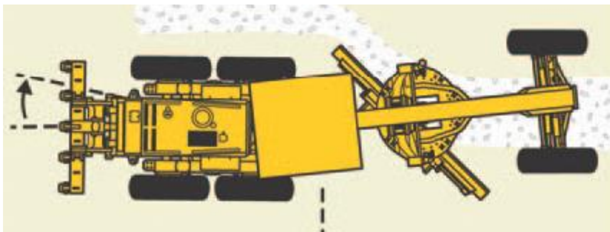
รูปที่ ๔-๓๗ การหักเลี้ยวกลางลำตัวช่วยลดมุมไบริดจ์เพื่อลดแรงปะทะของไบริดจ์
