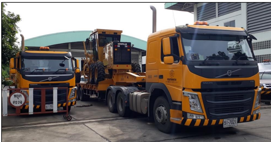
รูปที่ ๕-๙ การขนส่งรถเกลี่ยด้วยรถเทรลเลอร์
