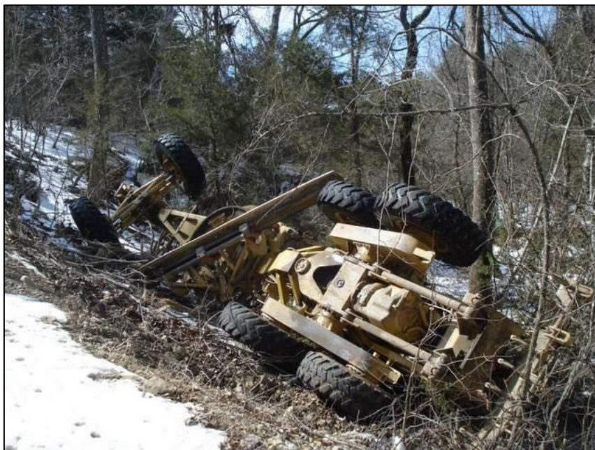
รูปที่ ๕-๔ รถเกี่ยพลิกคว่ำเนื่องจากทำงานบนพื้นที่ลาดเอียงมากเกินไป
