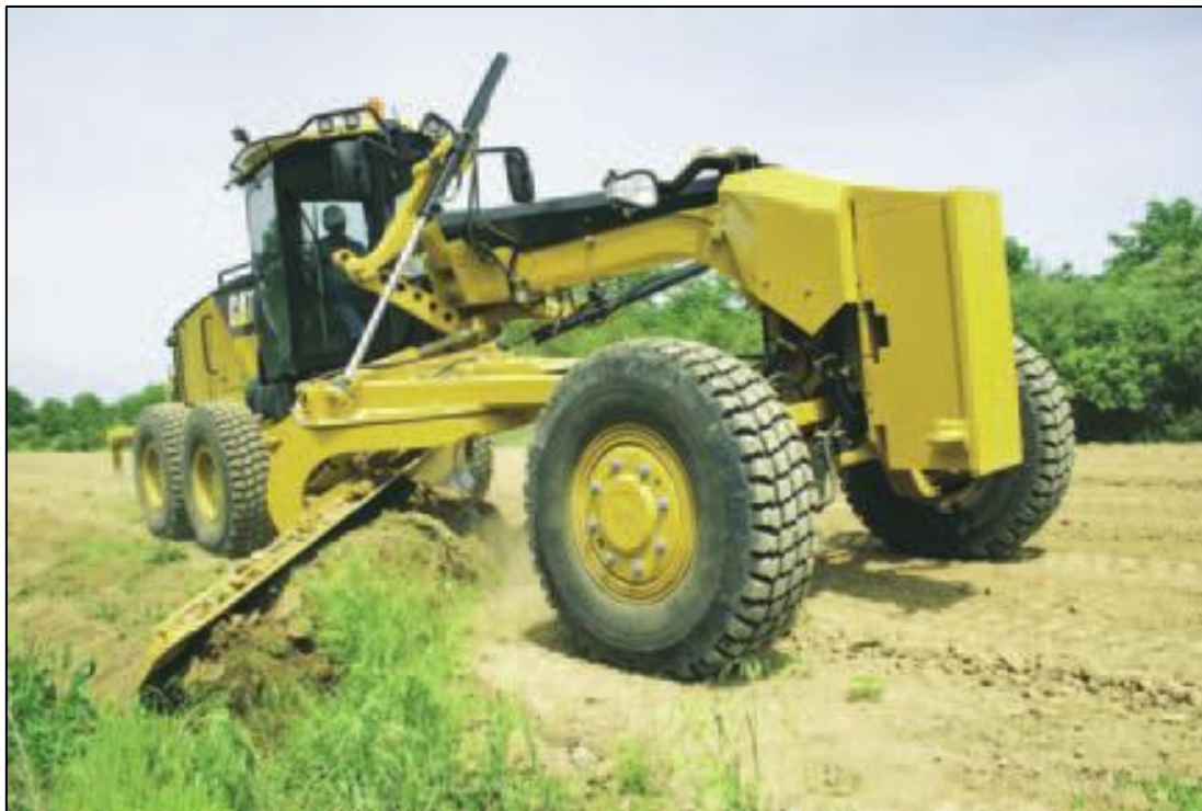
รูปที่ ๓-๔๔ การเลื่อนใบมีดและชุดวงเดือนออกด้านข้างเพื่อปาดไหล่ทาง
