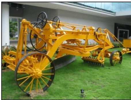
รูปที่ ๑-๑๖ รถเกี่ยลากจูงที่ใช้วงล้อหมุนควบคุม(พิพิธภัณฑ์กรมทางหลวง)
