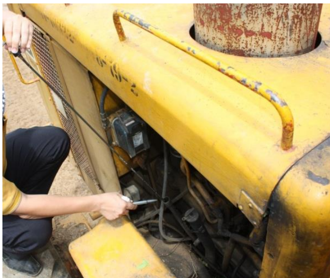
รูปที่ ๔-๑๓ การตรวจเช็คระดับน้ำมันห้องเกียร์
