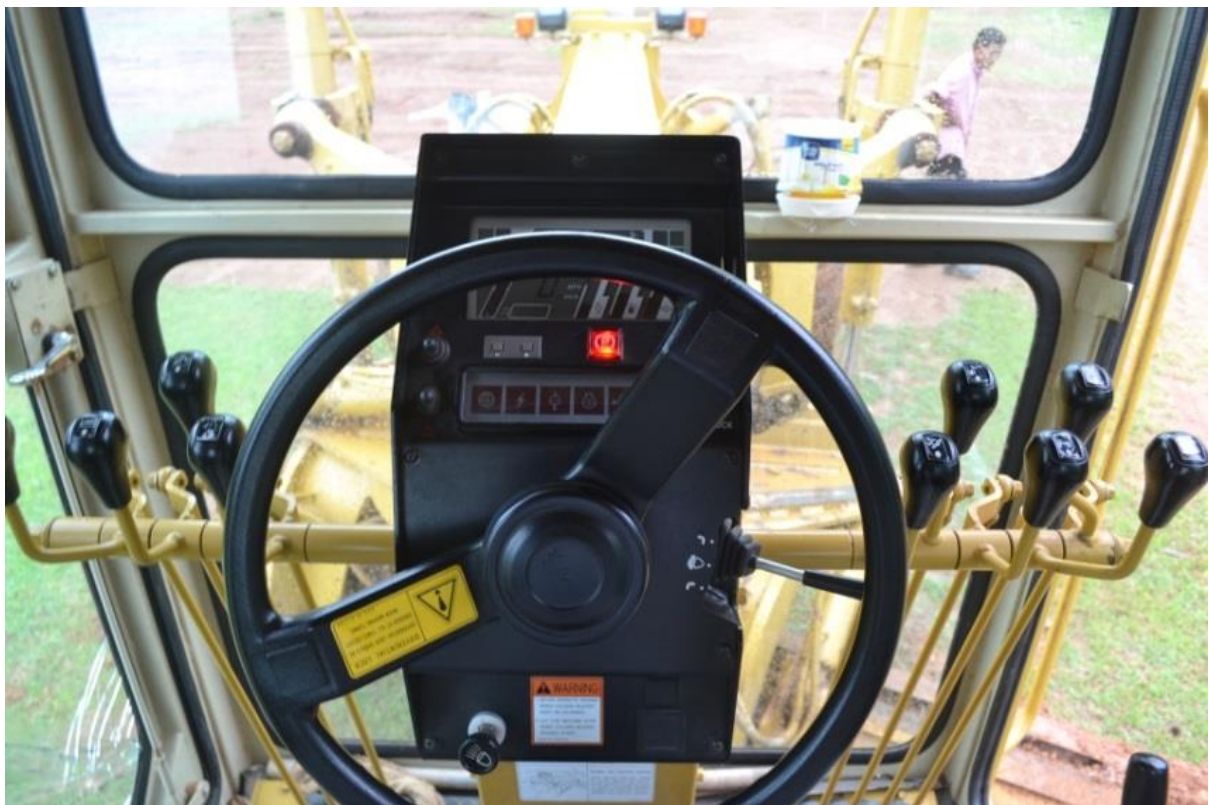
รูปที่ ๔-๒๑ ไฟสัญญาณเตือนบนแผงหน้าปัด
