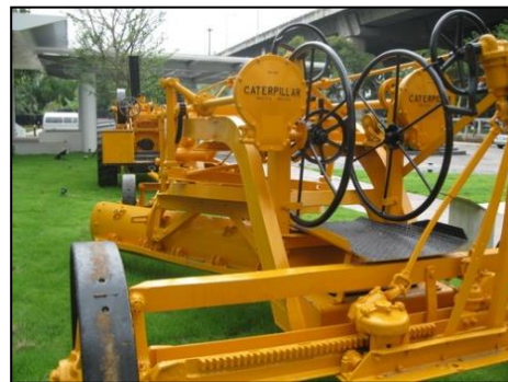
รูปที่ ๑-๑๖ รถเกี่ยลากจูงที่ใช้วงล้อหมุนควบคุม(พิพิธภัณฑ์กรมทางหลวง)
