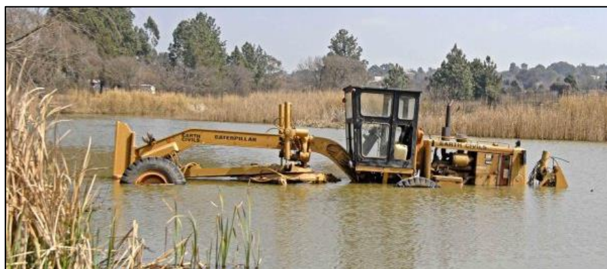
รูปที่ ๕-๗ การจอตรถเกลี่ยไว้บริเวณพื้นที่เสี่ยง ทำให้น้ำท่วมเครื่องจักร
