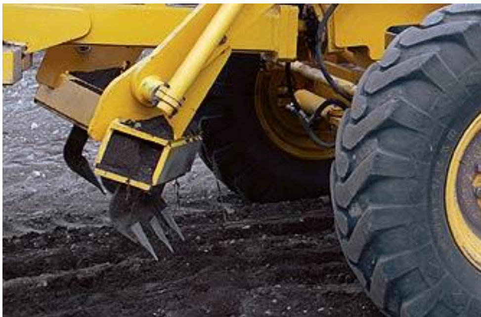
รูปที่ ๓-๔๘ คราดขนาดเล็กที่ติดตั้งด้านหน้าชุดไถมีด
