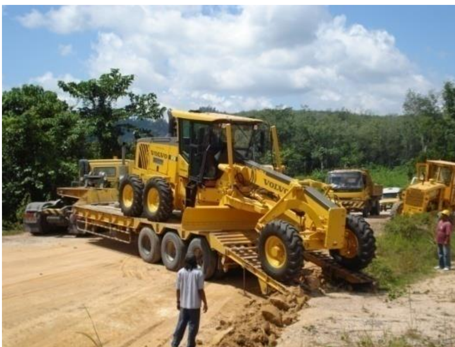
รูปที่ ๔-๔๖ การขนส่งเครื่องจักรกรณีที่ ๒
