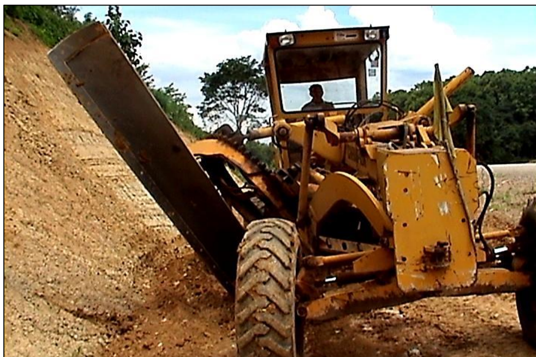
รูปที่ ๓-๔๕ การยกใบมีดและชุดวงเดือนออกด้านข้าง
