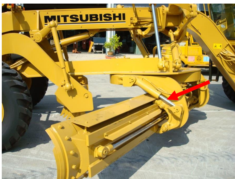
รูปที่ ๓-๔๑ การหมุนไ้มต์ ด้วยกระบอกไฮดรอลิก
