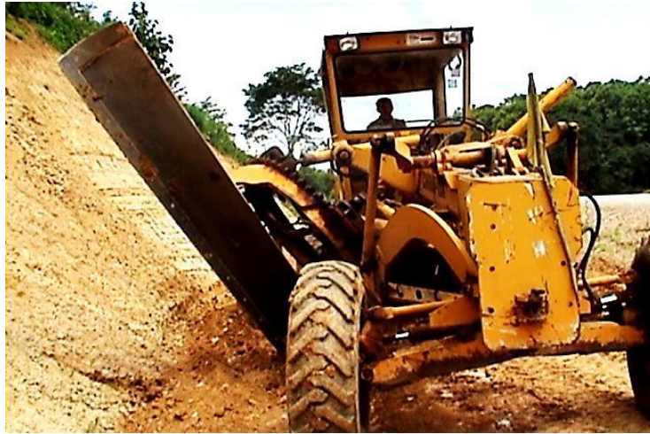
รูปที่ ๔-๕๐ การยกชุดไ้มีดขึ้นสูงสำหรับการตัดปาดเนินสูง
