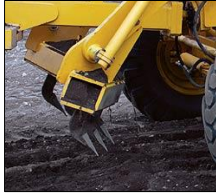
(ก) คราดขนาดเล็กที่ติดด้านหลังของรถ(ข) คราดขนาดเล็กที่ติดด้านหน้าชุดใบมีด
