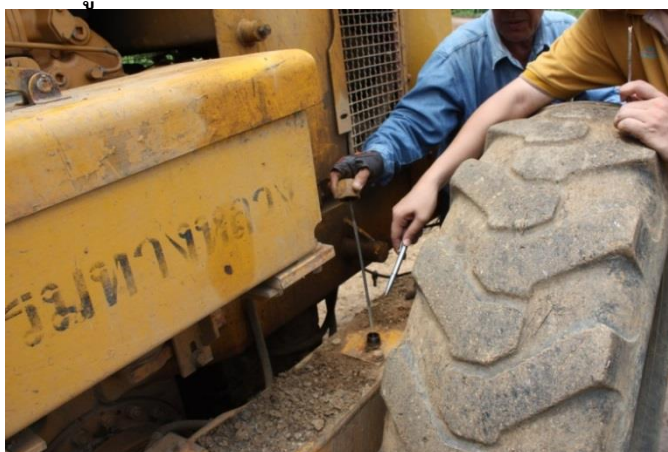
รูปที่ ๔-๑๔ การตรวจเช็คระดับน้ำมันห้องโซ่
