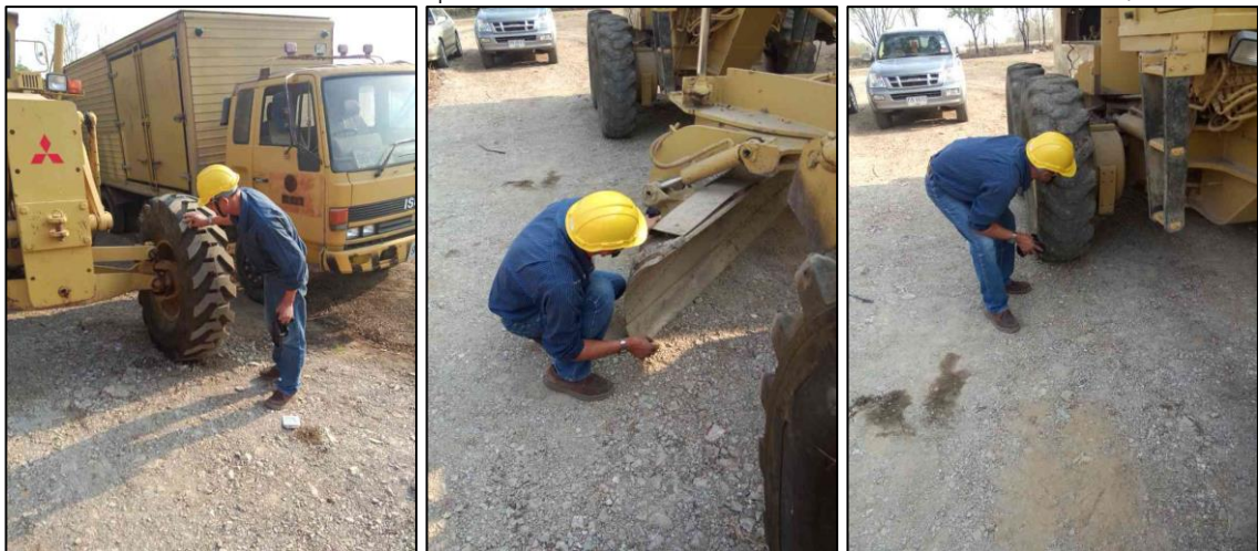
รูปที่ ๔-๑๒ การตรวจสอบสภาพเครื่องจักรโดยรอบก่อนการใช้งาน
