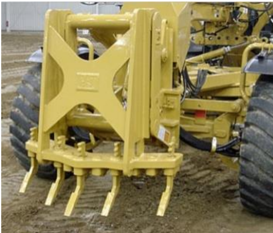
รูปที่ ๓-๔๗ คราดขนาดเล็กที่ติดตั้งด้านหน้าของรถ
