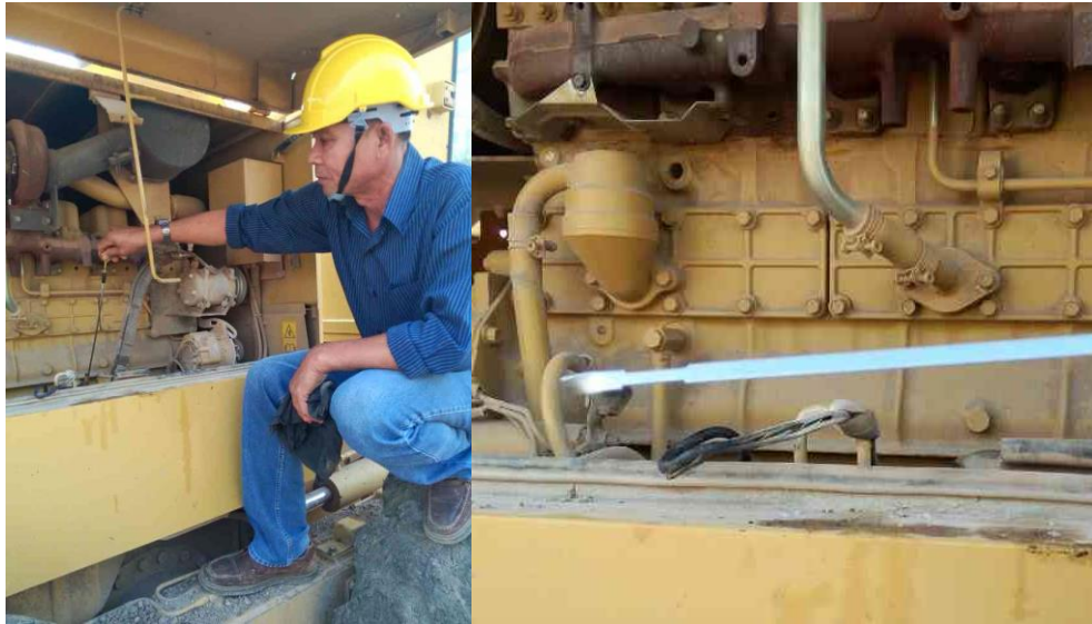
รูปที่ ๔-๑๕ ตรวจสอบระดับน้ำมันเครื่องยนต์
