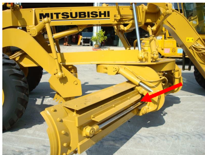
รูปที่ ๓-๔๐ กระบอกไฮดรอลิกเลื่อนไ้มต์ออกด้านข้าง
