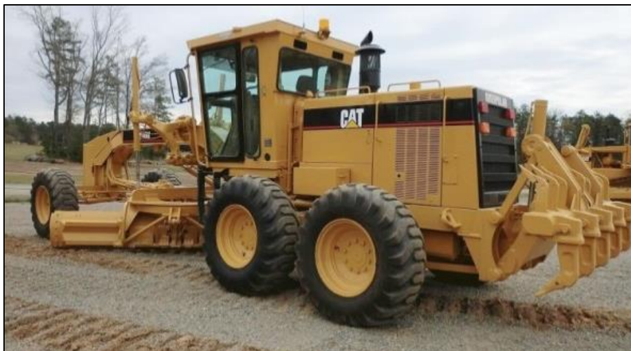
รูปที่ ๑.๒๑ ริปเปอร์ที่ติดหลังรถเกลี่ย
