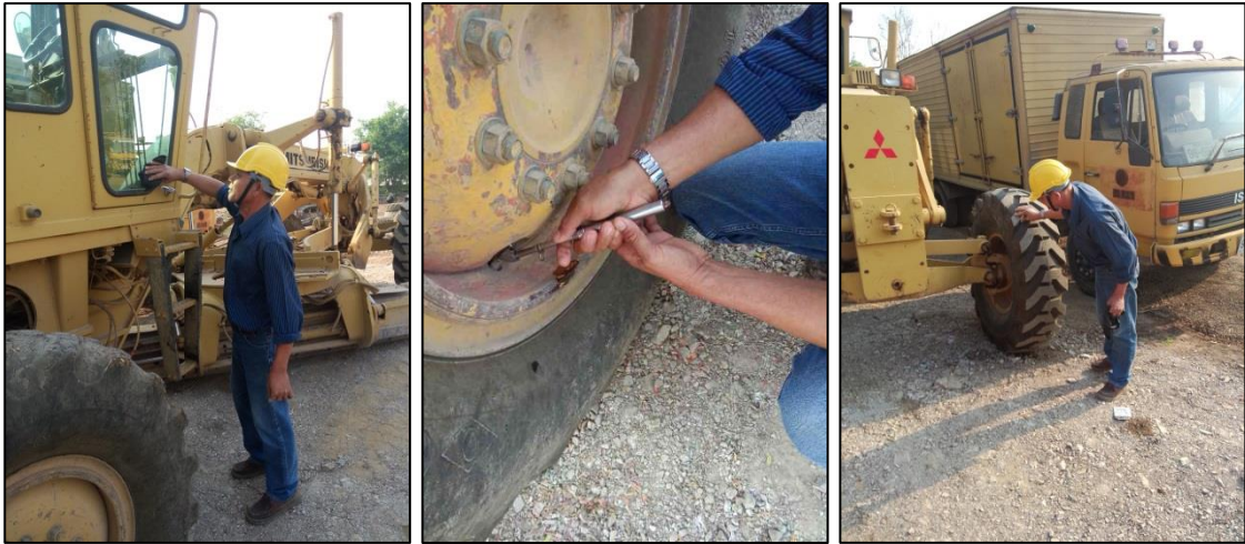
รูปที่ ๔-๑๑ เช็ดทำความสะอาดกระบอก(ซ้าย) ตรวจเช็คแรงดันลมและสภาพยาง(กลาง-ขวา)
