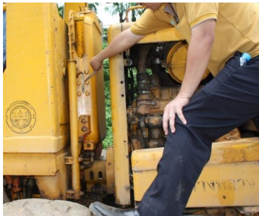
รูปที่ ๔-๑๖ การตรวจสอบระดับน้ำมันไฮดรอลิก
