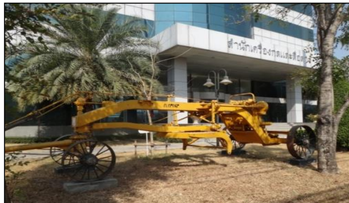
รูปที่ ๑-๑๗ รถเกี่ยลากจูงที่ใช้เครื่องยนต์ช่วยผ่อนแรงควบคุมการทำงาน(สำนักเครื่องกลฯ)
